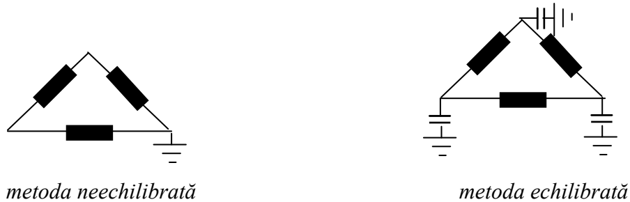
Fig. 2. Soluții de potențializare a înfășurării terțiare în \Delta a unui transformator cu trei înfășurări
